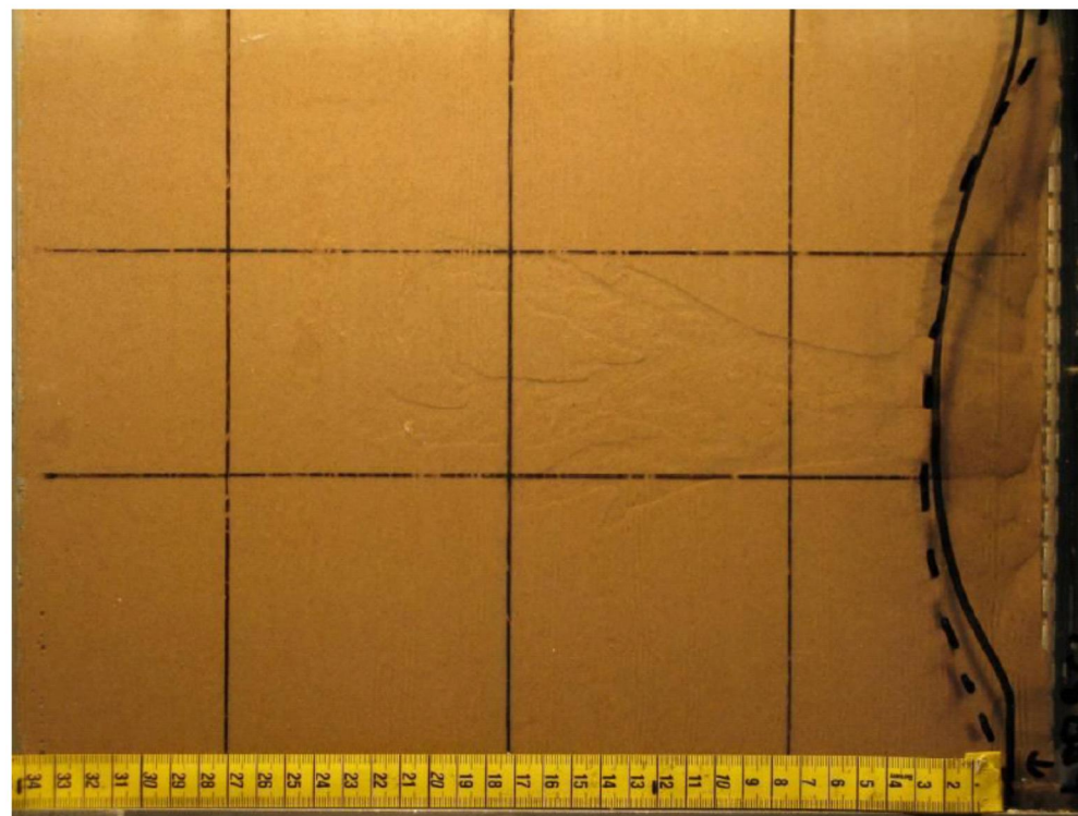
Bovenaanzicht van vertakkende pipe-ontwikkeling in een kleine-schaalproef.
