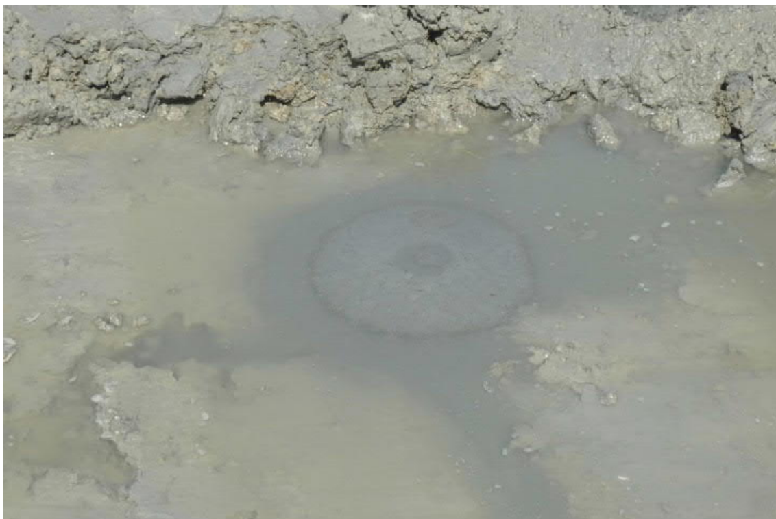
Figuur B.3 Een wel (diameter van de conus 0.5 m) in een omgeving van getijdenafzettingen, ongeveer 8 m –NAP en 4 m beneden maaiveld en 1 m boven een getijdengeulafzetting.
