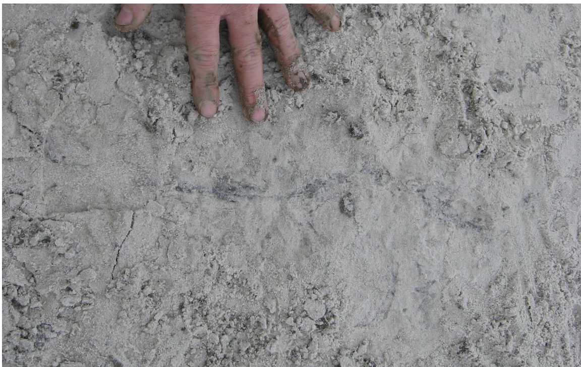
Figuur B.2 Spoor van een kleine tunnel (mm afmetingen), zoals waargenomen in het zand direct onder een kleiafdekking in een schaalproef. Het spoor van het tunneltje heeft dezelfde karakteristieken als in proeven met een laboratoriumopstelling (concentratie van korrels van zwaardere mineralen, verwilderend patroon, breedte van zo'n 10 mm). Deze sporen verdwenen en ontstonden direct onder de kleiafdekking bij kleine, centimeter schaal, onregelmatigheden in de basis van het kleidek.
